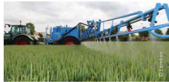
Je nach Situation auf dem Feld werden am Gestänge ganz unterschiedliche Düsen montiert, teils auch Rohre oder Schläuche für die Unterblattspritzung oder Bodenausbringung.
