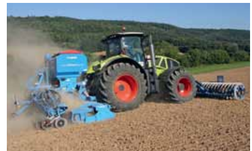
Der Traktor besitzt an der Front und am Heck Kupplungen für Anbaugeräte. Das Bild zeigt vorne einen Packer zur Saatbettvorbereitung, gleichzeitig auch Gegengewicht für die Sämaschine mit Kreiselegge hinten.
