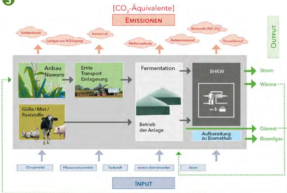
Quelle: LLH, aus: Lernpaket „Biogas – Energie aus Biomasse“
