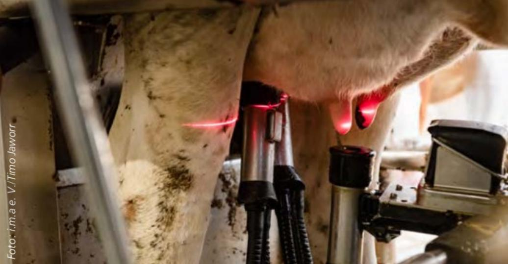
*Bei automatischen Melksystemen sorgen Kamera und Laser dafür, dass die Melkbecher die Zitzen finden und die Kuh gemolken werden kann.*
